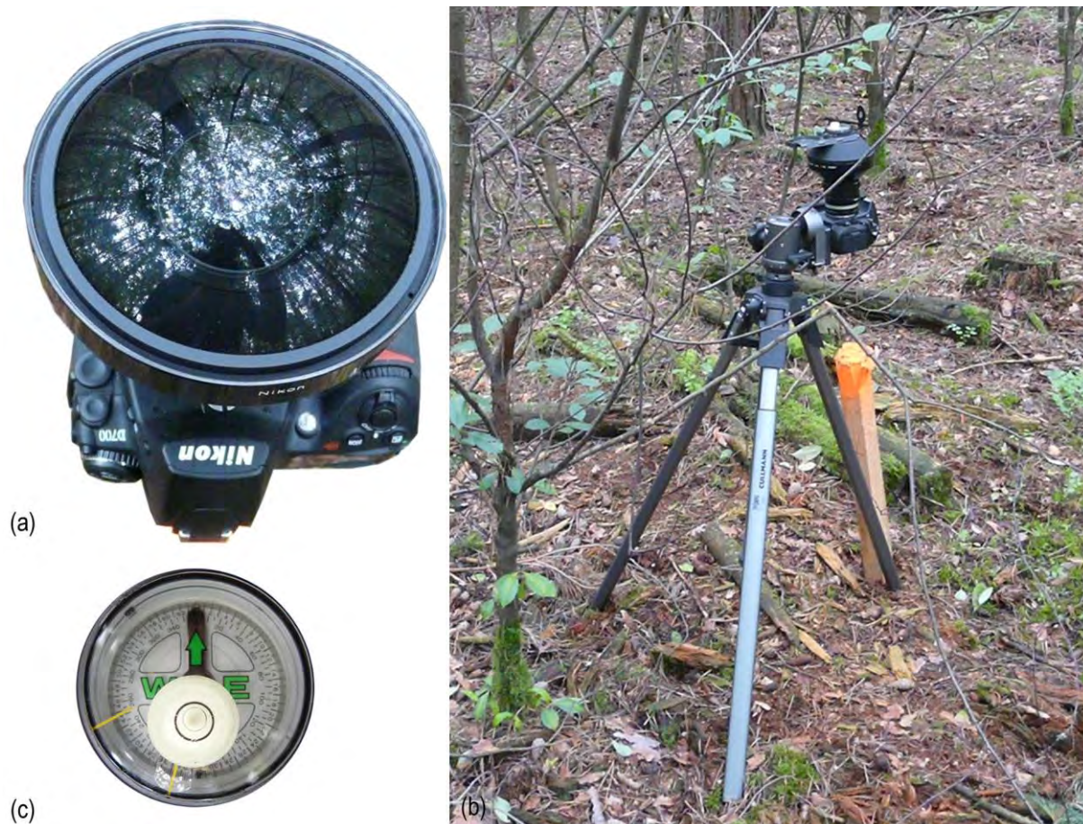
Abbildung 5: (a) Die Aufnahme der hemisphärischen Fotos erfolgte mit einer digitalen Spiegelreflexkamera Nikon D700, die mit einem Nikon 8 mm f/2.8 Fisheye-Objektiv ausgerüstet war. (b) Die Abbildung zeigt die über dem Probepunkt auf einem Stativ etwa 0,8 m oberhalb des Erdbodens eingerichtete Kamera. (c) Vor jeder Aufnahme wurde die Kamera mit einem Kompass und einer Dosenlibelle ausgerichtet.
